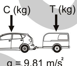
$$D \geq \frac{T \cdot C}{T+C} \cdot \frac{g}{1000} \text{ (kN)}$$
