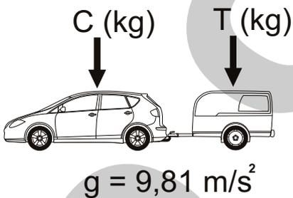
$$D \geq \frac{T \cdot C}{T + C} \cdot \frac{g}{1000} \text{ (kN)}$$
